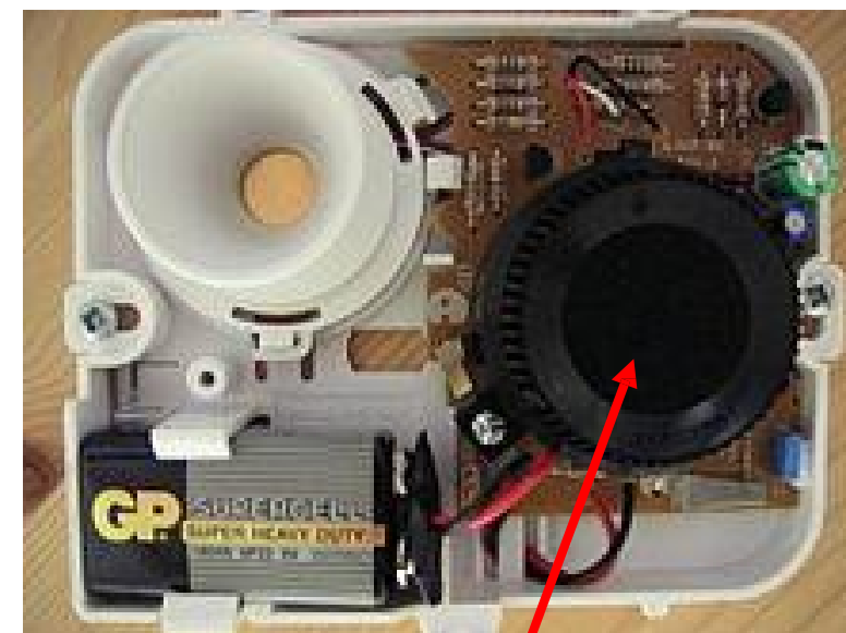
Ionizacijska celica z izvorom ^{241}\text{Am}
