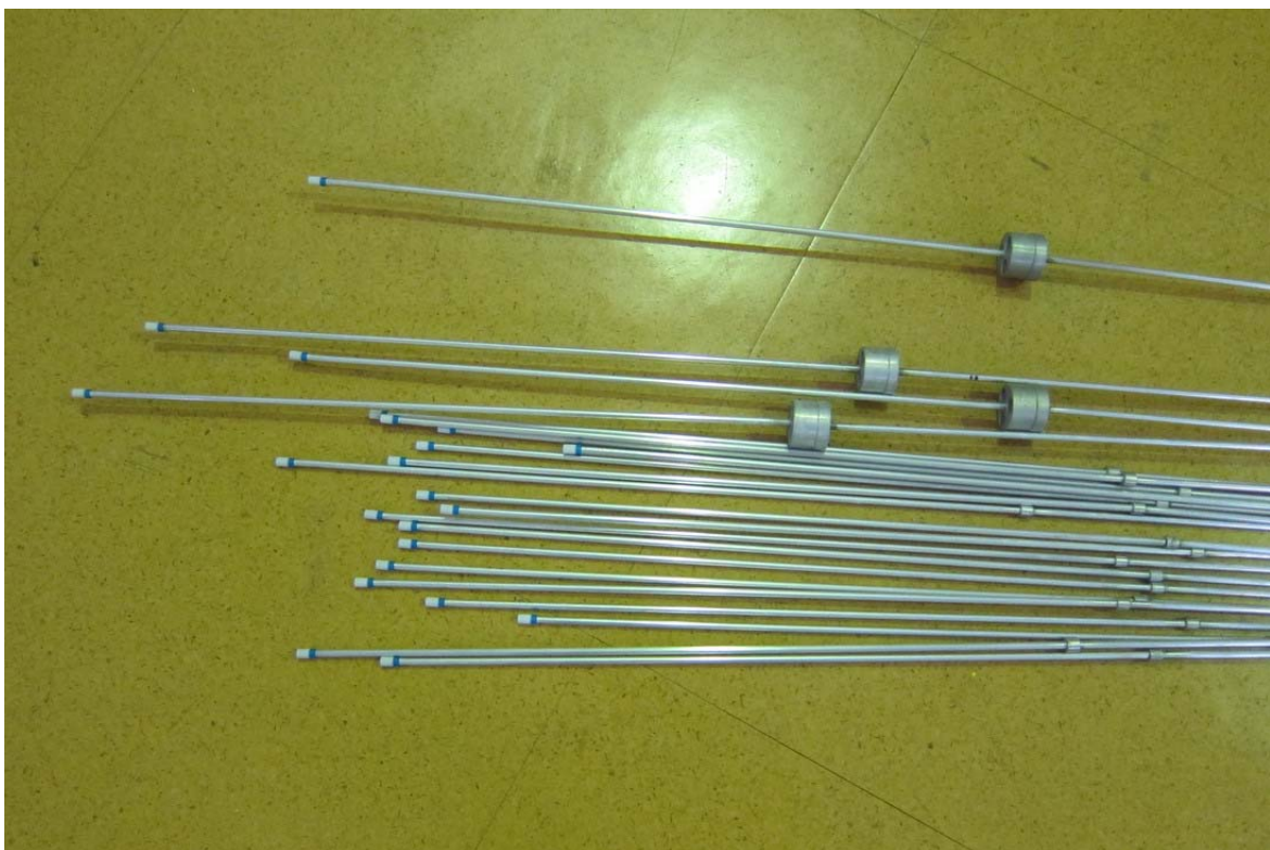
Slika 3: Spodnji del cevi za dovajanje mehurčkov.
