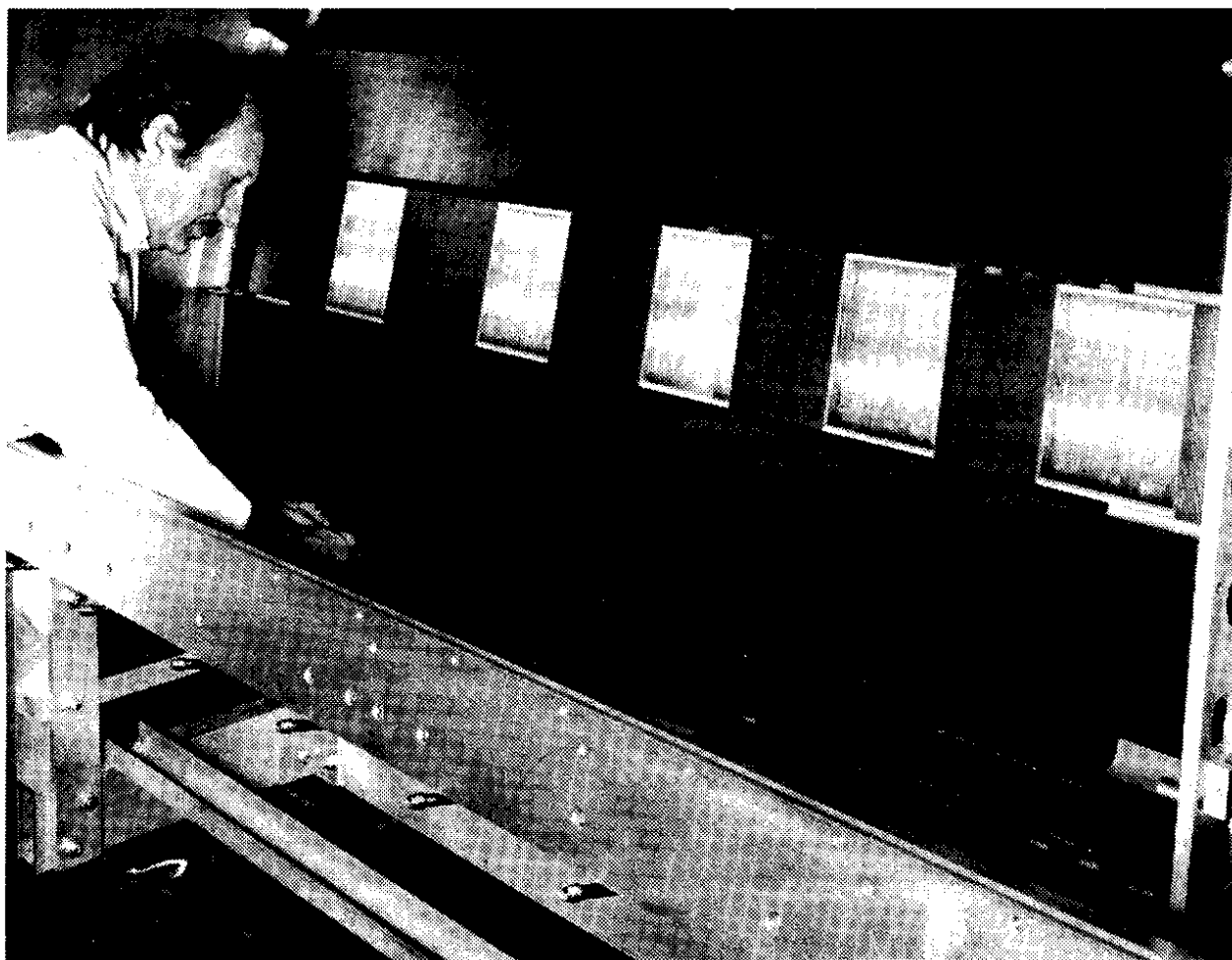
Fig. IV.23 Photographie de l'intérieur de l'enceinte, montrant la distribution des lignes équipotentiels et leur alimentation à partir du diviseur de potentiel au moyen de connexions flexibles en Kapton. La pièce centrale en aluminium, visible sur la photographie, est portée à -100 \text{ kV} .
