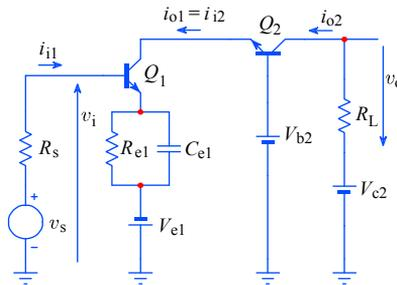
Fig. 3.4.1: Cascode amplifier schematic
