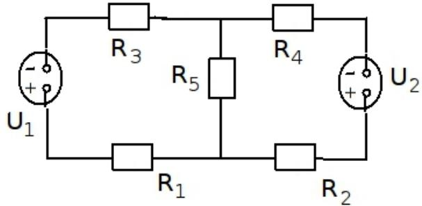
V vezju nato odklopimo generator  $U_2$ , vse upore nadomestimo z kondenzatorji ( $C_1 = 10\mu F$ ,  $C_2 = 20\mu F$ ,  $C_3 = 30\mu F$ ,  $C_4 = 40\mu F$ ,  $C_5 = 50\mu F$ ), ter generator  $U_1$  nadomestimo z generatorjem izmenične napetosti  $U(t)$  z amplitudo  $U_0 = 311V$  in kotno frekvenco  $\omega = 314 \text{ rad/s}$  (glej sliko spodaj).
