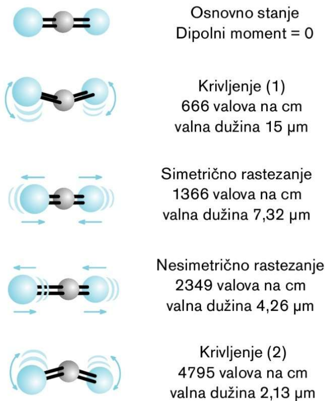
Sl.16. Oscilacije molekule \text{CO}_2 s pripadajućim frekvencijama i valnim dužinama.
