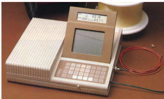
Sl.4: OTDR, razvit v sodelovanju z Elektrooptiko.
