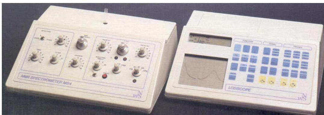
Sl.5: MRI Spektrometer. Instrument na levi strani vsebuje magnet, ter RF oddajnik in sprejemnik.
