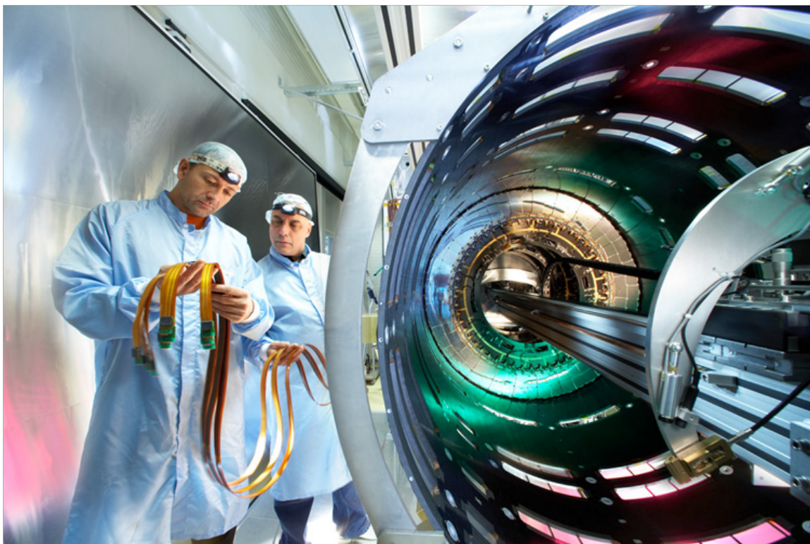
Slika 7: Sestavljanje pasovnega silicijevega detektorja. Napajalni gibljivi kabli, ki jih pregledujeta inženirja, so bili narejeni v Sloveniji.
