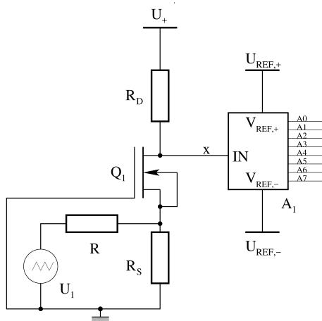
V vezju na sliki je  $U_+=5$  V,  $R_D=200$   $\Omega$ ,  $R_S=1$  k $\Omega$  in  $R=1$  k $\Omega$ . Napetostni izvor  $U_1$  daje žagasto napetost z amplitudo 5 V in frekvenco 10 kHz. Analogno-digitalni pretvornik  $A_1$  vzorci s frekvenco 400 kHz med referenčnima napetostima  $U_{\text{REF},+}=U_{\text{REF},-}=2$  V. MOSFET  $Q_1$  je n-kanalni, s pragom  $U_T=2$  V in referenčnim tokom  $I_{DS}(U_{GS,\text{REF}}=5$  V)=1 mA. Zapiši prvih deset zaporednih pretvorb ADCja!
