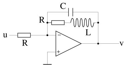
V vezju na sliki je  $R=3$  k $\Omega$ ,  $L=0.1$  mH. Izberi kapaciteto kondenzatorja  $C$ , da bo največje ojačanje vezja pri  $\omega_0=100$  MHz. Oceni tudi ojačanje  $A_{\max}$  pri tej frekvenci. Poisci pasovno širino ojačevalca, kjer bo ojačanje večje od -6 dB glede na  $A_{\max}$ !
