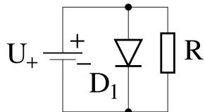
V vezavi na sliki teče skozi diodo tok  $I_D=2$  mA. Kakšen tok teče skozi generator napetosti z napetostjo  $U_+=5$  V, če ima upornik  $R$  upornost  $R=2$  k $\Omega$ ? Kakšen tok teče skozi generator, če diodo odstranimo?
